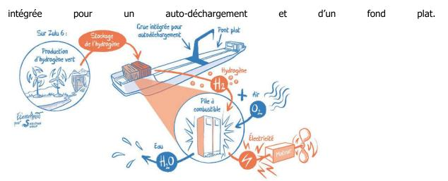
Ce bateau offre une capacité équivalente à 50 camions et permet ainsi diminuer le recours au transport routier en valorisant une voie fluviale sous utilisée. Son alimentation en hydrogène est assurée par un stockage sur le bateau de l'hydrogène.
