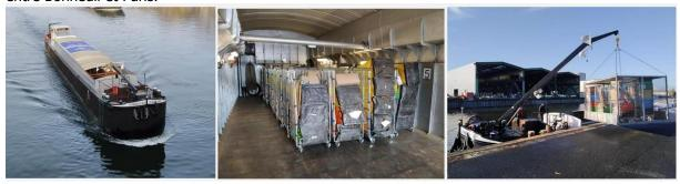
Le bateau Fludis 100% électrique, offre à la fois un moyen de transport fluvial, des locaux d'activité logistique et des équipes de personnel travaillant à bord. Ce bateau électrique auto-déchargeant ne nécessite aucune infrastructure à quai, permettant la préparation des tournées des vélos-cargos à bord en navigation 53/7 dans Paris.
